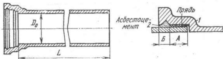
Рис. 77. Чугунная раструбная труба 1 — труба; 2 — заделка раструба
